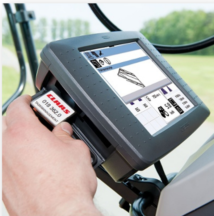
Εικόνα 2α: Εξωτερική μονάδα αποθήκευσης σε θεριζοαλωνιστική μηχανή (Πηγή CLAAS, 2013)
